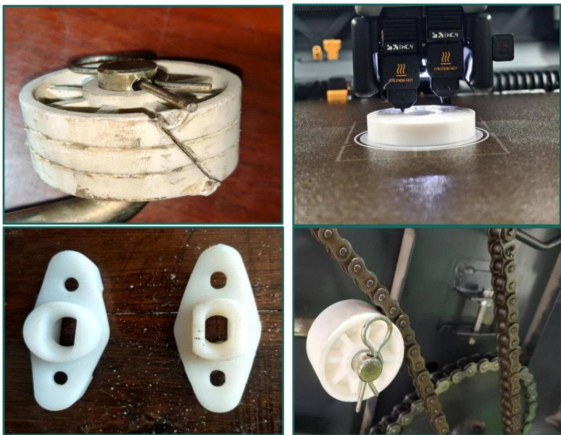
技术跨界融合案例——收割机割台异形件快速成型
